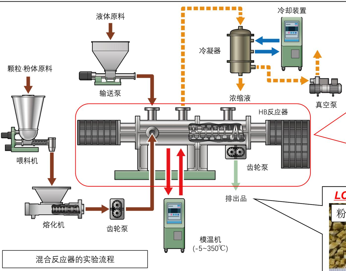
拥有“高真空度”，“长滞留时间”，“能处理高粘度物料”等特性的双螺杆连续式反应器
